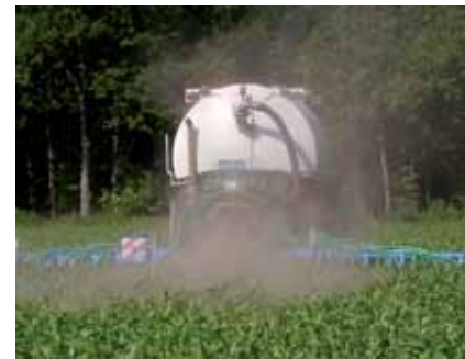
► Abb. 17: Wirtschaftsdüngeraufbringung mittels Schleppschuh (Landwirtschaftskammer Niedersachsen)
