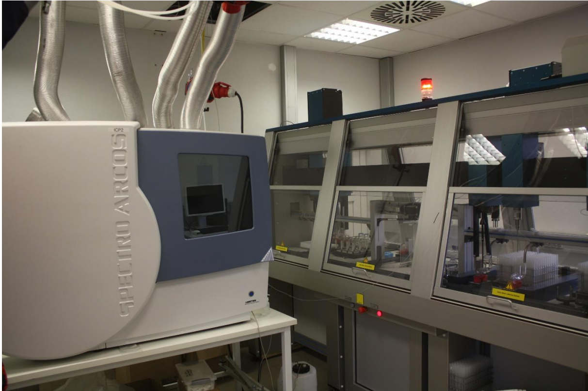
Abbildung 8: Online-ICP-OES und Probenvorbereitungssystem im Mess- und Analytikraum
