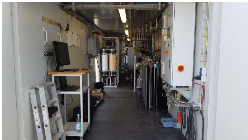
Abbildung 6: Versuchscontainer mit NF-Hockdruckmodulen und Ultrafiltrationsgestell
