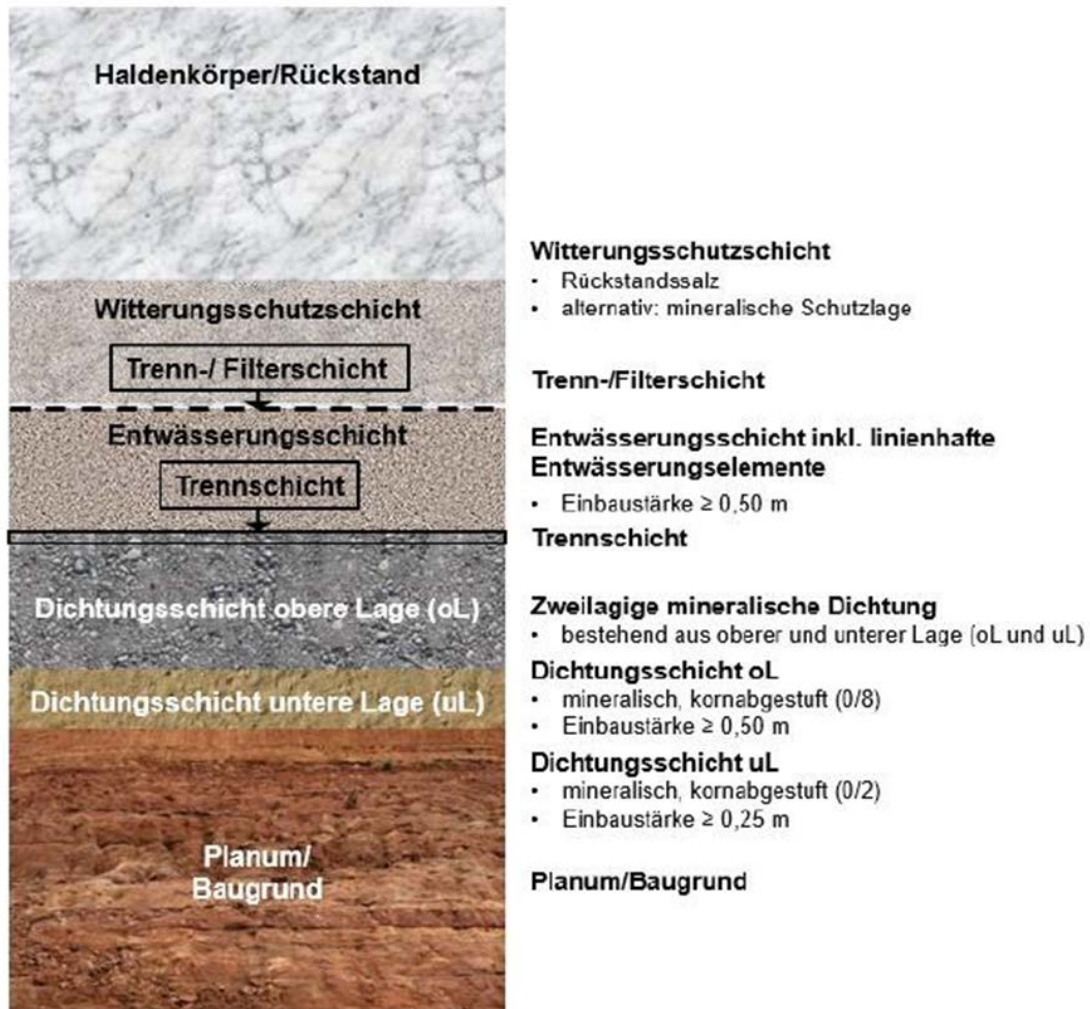
Abbildung 5: Schichtenaufbaus der vorgesehenen mineralischen Dichtungsschicht
