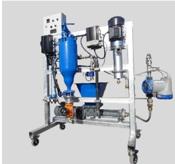
Abbildung 10: Schaumbeton-Versuchsanlage zur Sorelschaumerzeugung
