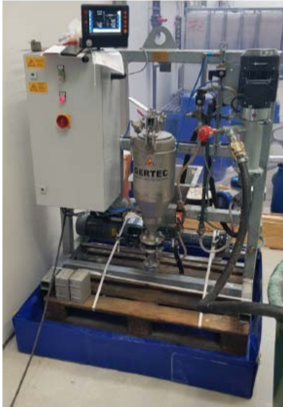
Bild 1. Schaumbetonmischer
