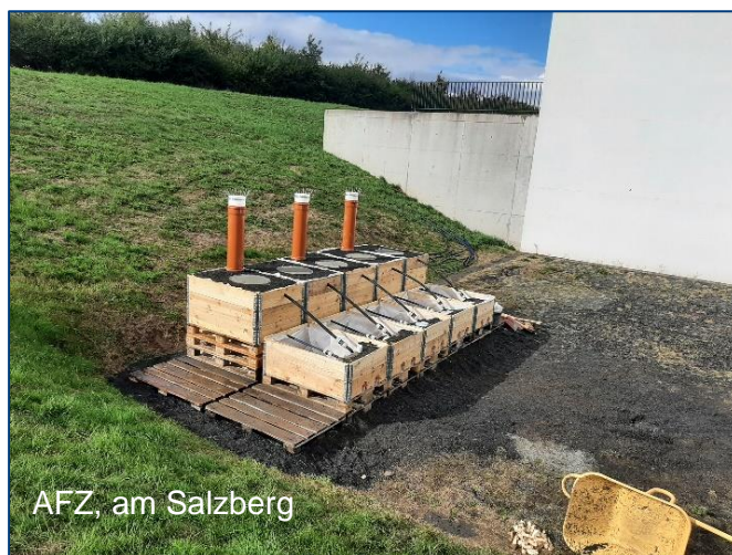
Abbildung 7: Die drei eingebauten Lysimeter an ihrem jeweiligen Haldenstandort
