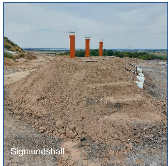
Abbildung 7: Die drei eingebauten Lysimeter an ihrem jeweiligen Haldenstandort
