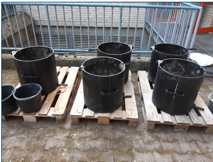
Abbildung 5: Einzelangefertigte Lysimetergefäße und deren Befüllung (rechtes Foto)
